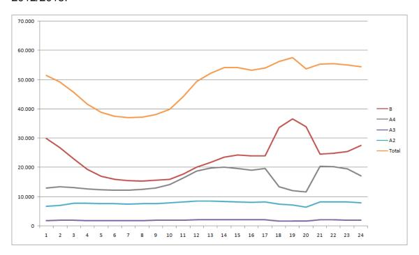
As quatro curvas apresentadas no Gráfico e que, somadas formam a "Total" referem-se a um nível de tensão de distribuição e foram construídas pelo INEE - Instituto Nacional de Eficiência Energética, com as médias mensais, lançadas ao longo de um dia, das demandas máximas das 61 Distribuidoras de Eletricidade do país:
